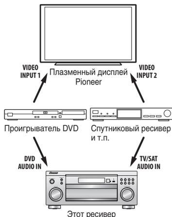
Для оптимального использования функций SR+ необходимо подсоединить компоненты источников (проигрыватель DVD и т.д.) немного иначе по сравнению с тем, как описано в данном разделе. Подсоедините видеовыходы каждого компонента непосредственно к плазменному дисплею и аудиовыходы (аналоговые и/или цифровые) подсоедините к данному ресиверу.
