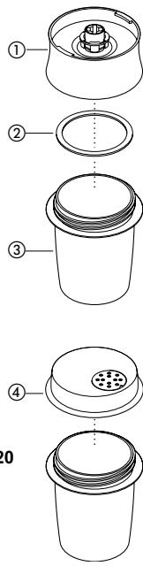
**Примечание. Основание мельницы и стеклянная емкость измельчителя FP920 не являются взаимозаменяемыми деталями. Если установлено не то основание, то кухонный комбайн не будет работать. См. графические символы на основании ножевого блока.**
