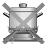
Не используйте на конфорках большого диаметра посуду небольших размеров. Пламя не должно касаться боковых стенок посуды.
