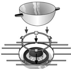
В зависимости от модели Ваша варочная панель может иметь дополнительную решетку. Эта решетка необходима при пользовании трехконтурной конфоркой для кастрюль диаметром более 26 см, сковород, кастрюль из жаропрочного материала и всех видов посуды с вогнутым дном (рис. 2).
