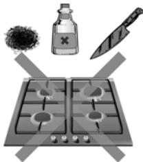
Для удаления с поверхности варочной панели, решеток, газовых и электрических конфорок приставших остатков пищи **не пользуйтесь абразивными средствами**, острыми предметами, стальными щетками, ножами и т.д.
