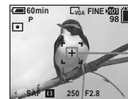
Перекрестие светового фотометрического пятна
