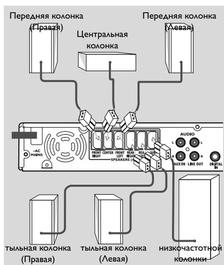
Подсоедините входящие в комплект колонки с помощью входящих в комплект кабелей. При этом цвета кабелей колонок должны соответствовать цветам разъемов. Неизолированный конец провода колонки вставляйте в разъем полностью.
