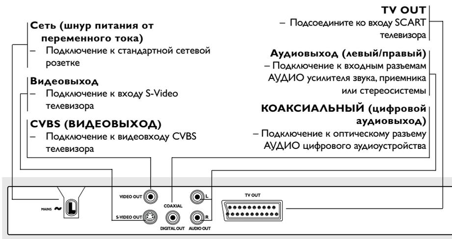
**Осторожно:** Не дотрагивайтесь до внутренних контактов разъемов, расположенных на задней панели. В противном случае электростатический разряд может вывести устройство из строя.
