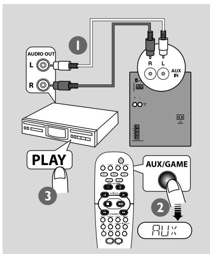
→ Если у подсоединяемого устройства только один разъем аудиовыхода, подсоедините его к левому разъему AUX IN. Можно также использовать кабель-разветвитель (переходящий с одного на два конца), но выходное звучание все равно останется монофоническим.
