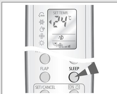
Таймер "сон" может использоваться при охлаждении или обогреве вашей комнаты для того, чтобы кондиционер автоматически выключался по истечении шести часов.
