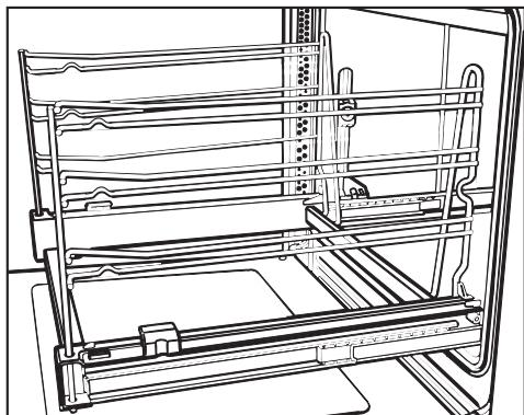
Телескопическую тележку с четырьмя уровнями загрузки можно полностью выдвинуть из духовки. Таким образом, обеспечивается оптимальный обзор приготовляемого блюда на каждом уровне.
