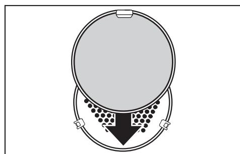
Капельки жира в циркулирующем воздухе улавливаются жиропоглощающим фильтром. Духовой шкаф и пространство за тыльной стенкой сохраняются в чистоте более длительное время.
