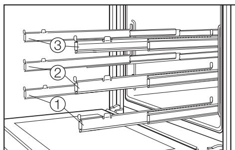
Телескопические направляющие образуют три яруса загрузки. Каждый ярус может быть полностью выдвинут из духового шкафа, что обеспечивает оптимальный обзор приготовливаемого блюда.
