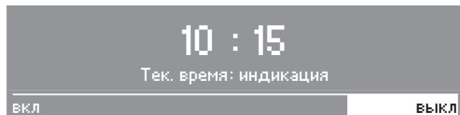
Если Вы выберете "выкл.", то дисплей погаснет через 60 секунд. Отсчет текущего времени происходит без индикации на дисплее. Индикация снова высветится на 60 секунд, если Вы слегка нажмете на кнопку ВКЛ / ВЫКЛ или функциональный переключатель.
