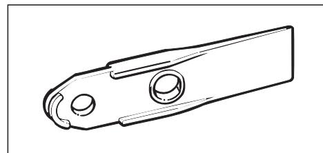
Монтажная лопатка используется для снятия плафонов галогенных ламп.
