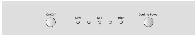
При включении холодильника в сеть, все индикаторы на панели управления мигают в течение 2 секунд и температура автоматически устанавливается на Уровень 3. При работе на Уровне 3 температура в холодильной камере будет поддерживаться равной 5°C, а в морозильной камере - равной -18°C.
