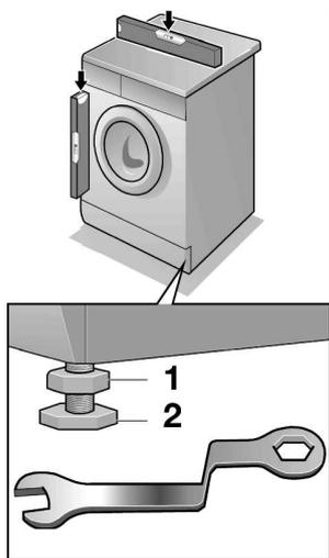
! Стиральная машина не должна качаться, все четыре ножки стиральной машины должны твёрдо стоять на полу.
