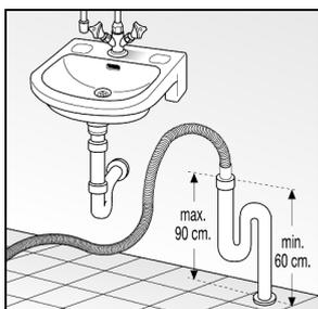
! Устанавливая и подключая стиральную машину к канализации, следите, чтобы шланг не имел перегибов и не был пережат. Следите, чтобы шланг не был сильно натянут!
