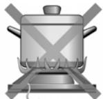
Не используйте на горелках большого диаметра посуду больших размеров. Пламя не должно касаться боковых стенок посуды.
