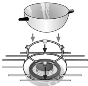
В зависимости от модели Ваша варочная панель может иметь дополнительную решетку. Эта решетка необходима при пользовании двух- или трехконтурной конфоркой для кастрюль диаметром более 26 см, сковород, кастрюль из жаропрочного материала и всех видов посуды с вогнутым дном (например, «WOK»), рис. 2.
