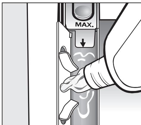
При выполнении последнего полоскания добавка смывается в барабан. После окончания программы стирки в отсеке ☼ остается небольшое количество воды.
