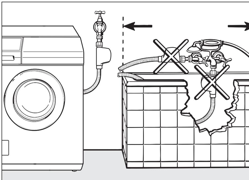
Клапан безопасности содержит электрические детали. Поэтому его нельзя монтировать в области, где разбрызгивается вода, например, у ванны или душа. В этих случаях для удлинения заливного шланга используйте шланг в металлической оплетке, который можно приобрести в фирменном магазине или сервисной службе Miele.
