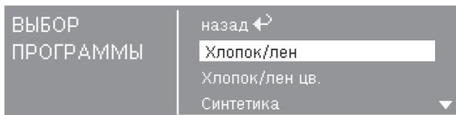
С помощью многофункционального переключателя Вы можете выбрать имеющиеся программы. Значок выделения смещается вверх или вниз в зависимости от направления вращения ручки многофункционального переключателя. Стрелки ▼▲ на дисплее справа указывают, имеются ли еще возможности выбора. При нажатии ручки многофункционального переключателя открывается основное меню выбранной программы стирки.
