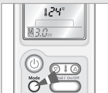
Таймер включения позволяет автоматически включить кондиционер через определенный промежуток времени. Вы можете установить значение этого промежутка равным от 30 минут до 24 часов.
