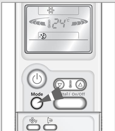
Таймер "сон" может использоваться при охлаждении или обогреве вашей комнаты для того, чтобы кондиционер автоматически выключался по истечении шести часов.
