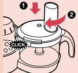
**2** Установите крышку на чашу. Поверните крышку по стрелке до щелчка (с небольшим усилием).
