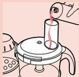
**1** Для добавления жидких и/или твердых ингредиентов используйте загрузочный бункер. Для продвижения твердых ингредиентов вниз по загрузочному бункеру пользуйтесь толкателем.
