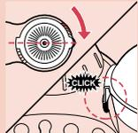
**2** Поверните сито в направлении стрелки до фиксации выступа на сите (вы услышите щелчок).
