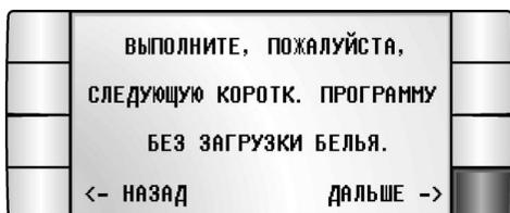
Перед тем как покинуть стены завода-изготовителя, стиральная машина подвергалась контрольным испытаниям. Для того чтобы удалить остатки воды, используемой при испытаниях, первую стирку следует провести без белья.
