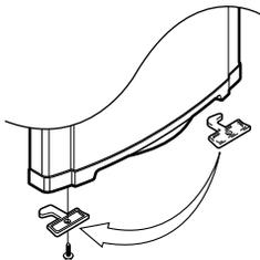
**10** Переставьте крышку на противоположную сторону дверцы морозильной камеры.
