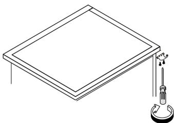
**2** Снимите Дверцу морозильной камеры..
