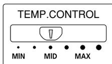
Кнопка регулировки температуры морозильной камеры по умолчанию установлена на положении СРЕДНИЙ УРОВЕНЬ.
