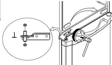
**9** Установите стопорный механизм дверцы морозильной камеры на нужную вам сторону.
