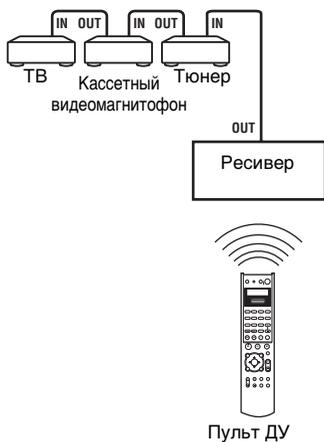
Сенсор ДУ данного аппарата получает коды ДУ таким же образом, как и сенсор ДУ компонента CONTROL S IN. Это полезно при размещении другого компонента на расстоянии от данного аппарата.
