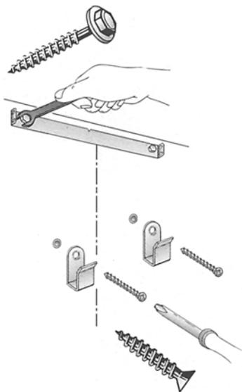
6. Подвесьте вытяжку. Выровняйте ее по высоте и по горизонтали с помощью регулировочных винтов.
