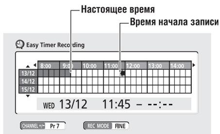
Каждый ряд таблицы соответствует одному дню (вы можете установить таймер записи на месяц вперёд). Каждый столбец соответствует 15 минутному интервалу времени. Темные участки отображают уже истекшее время, и по этому не могут быть выбраны. Светлые участки отображают время, которое вы можете использовать для записи.
