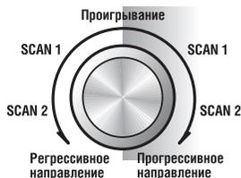
3 Используйте SMART JOG регулятор, чтобы изменить скорость сканирования и направление.
