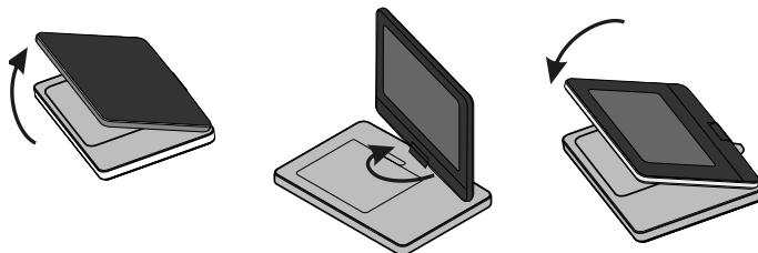
Чтобы повернуть ЖК панель, поставьте устройство на устойчивую и ровную поверхность, например, на стол. Поднимите ЖК панель, а затем переведите ее в вертикальное положение. Медленно поверните ЖК панель по часовой стрелке на 180 градусов. Если необходимо, сложите ЖК панель после поворота.
