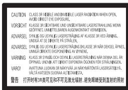
Данное устройство классифицируется как **ЛАЗЕРНЫЙ** продукт **КЛАССА 3R (CLASS 3R LASER)**. Если защитный кожух лазера открыт, из него исходит видимое и невидимое лазерное излучение, поэтому не подвергайте глаза прямому воздействию излучения. Эта маркировка расположена на защитном кожухе лазера внутри корпуса.
