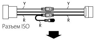
Если приемник не включается, используйте преобразованную схему соединений ②.
