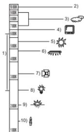
На рисунке выше показан диапазон, в котором функционирует автоматическая настройка баланса белого.
