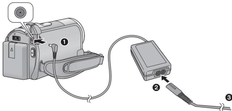
**1** Подключите адаптер переменного тока к входному разъему постоянного тока на данной камере.
