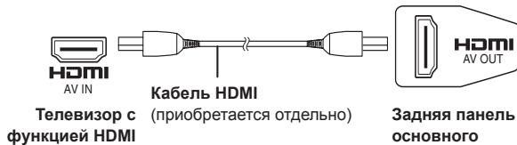
Используйте подключение HDMI для достижения повышенного качества звука и изображения при помощи одного кабеля (⇒ Значения терминов, HDMI, страница 37).
