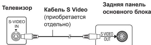
За счет разделения сигналов цветности (C) и яркости (Y) при использовании разъема S VIDEO (раздельный видеосигнал) достигается более живое изображение, чем при использовании разъема VIDEO OUT (видеовыход). (Реальный результат зависит от телевизора.)
