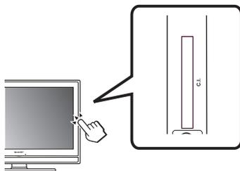
3. Осторожно вставьте 3. CI модуль в CI гнездо контактной стороной вперед. Логотип на CI модуле должен быть спереди, если смотреть на телевизор сзади. Не прикладывайте избыточных усилий. Убедитесь, чтобы модуль не был согнут.
