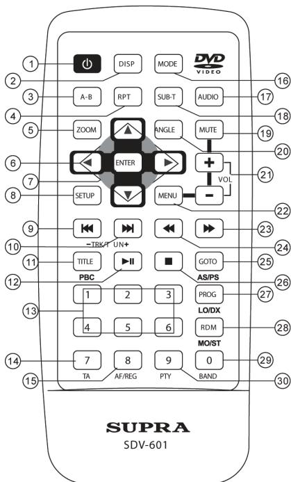
1. POWER Кнопка включения/выключения аппарата
