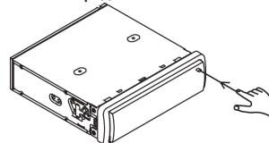
2. Снимите переднюю панель, как показано на рис.
