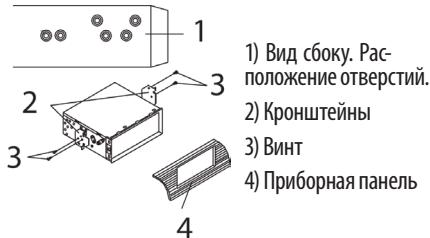
Выберите позицию, при которой винтовые отверстия кронштейнов, закрепленных в автомобиле, и винтовые отверстия приемника (отмеченные соответствующими буквами наименования марки машины «Т» – Toyota или «Н» – Nissan) совпадут, и закрепите проигрыватель при помощи 2-х винтов (5x5 мм) с каждой стороны.
