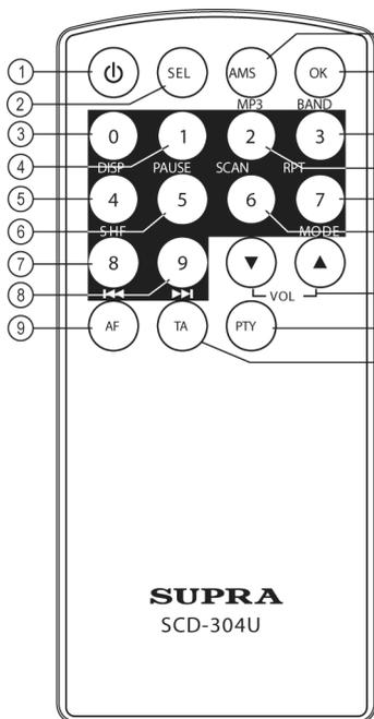
1. POWER  $\phi$  Кнопка включения/выключения аппарата
