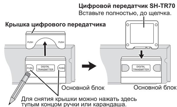
Перед установкой любых других дополнительных передатчиков снимите крышку передатчика.
