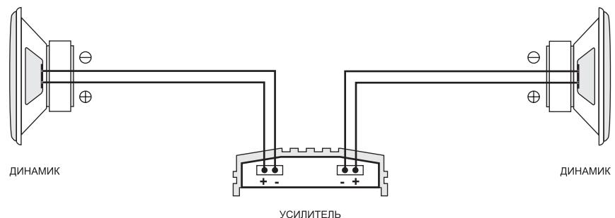
B) Схема подключения компонентных динамиков.
