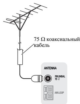
Для улучшения приема в диапазоне AM подключите к разъемам **AM LOOP** провод длиной 5 м до 6 м с виниловой изоляцией, не отсоединяя прилагаемую рамочную антенну AM.
