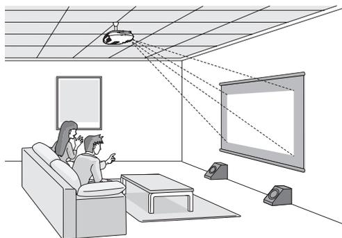
\* Даже если проецирование выполняется сбоку экрана, установите проектор так, чтобы экран и лицевая панель проектора были параллельны.
