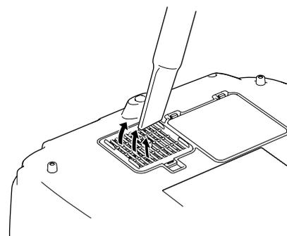
**Внимание!** Забитый пылью воздушный фильтр может способствовать перегреву проектора, что вызовет ошибки в его работе и сократит срок службы оптических компонентов. Рекомендуется очищать воздушный фильтр не реже одного раза в три месяца. Если проектор используется в пыльном помещении, чистку воздушного фильтра может потребоваться проводить чаще.
