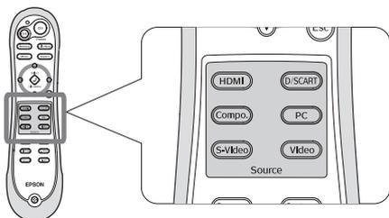
Нажмите кнопку с названием, соответствующим порту, к которому подключен источник сигнала.
