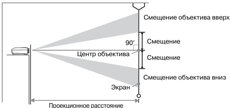
Расстояние от центра объектива до низа экрана варьируется в зависимости от смещения объектива.
