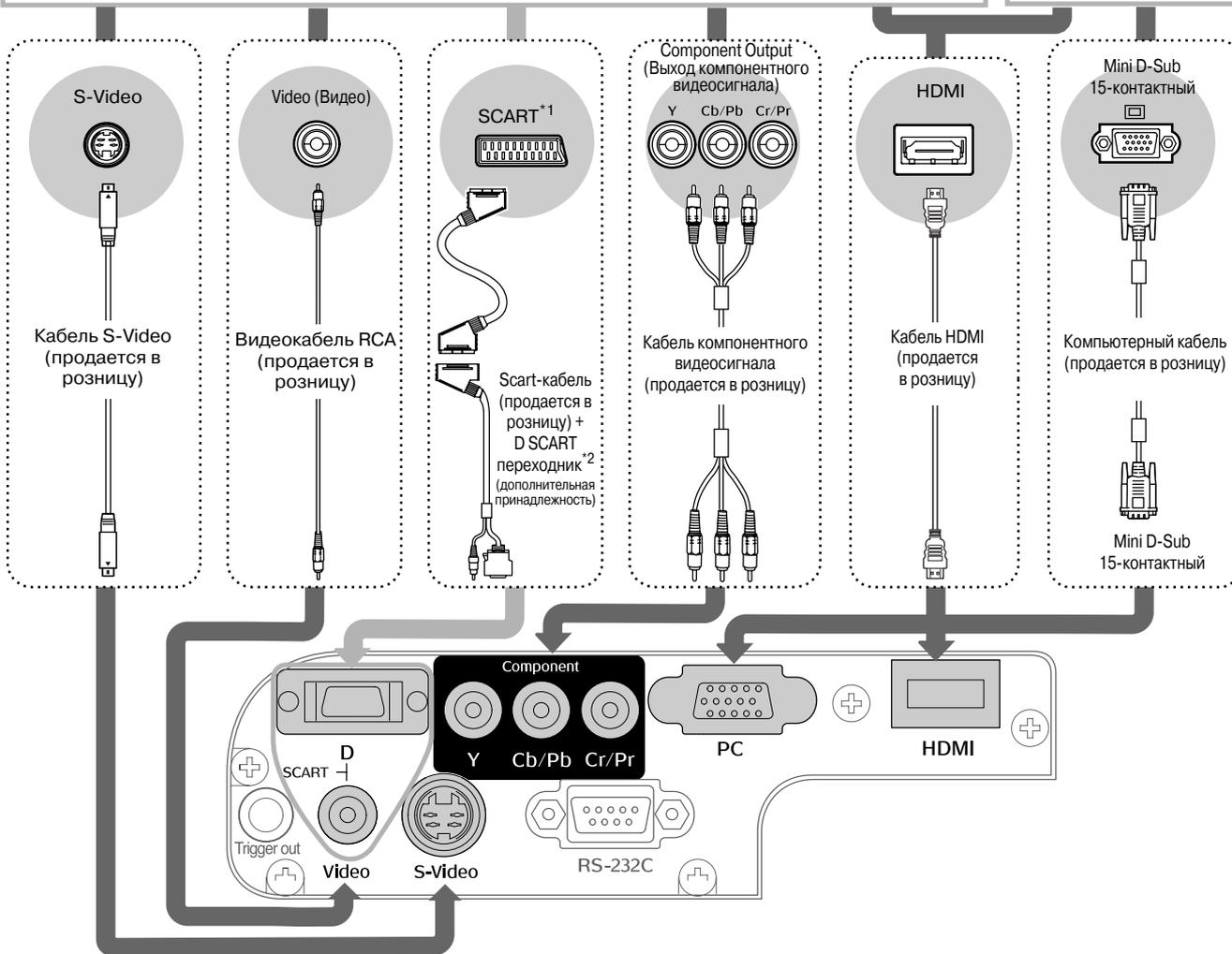
\*1 Если DVD подключается с использованием адаптера D SCART, следует задать параметру "D/SCART" в меню "Input Signal" (Входной сигнал) значение "SCART". "Выбор источника изображения" стр. 15
