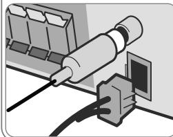
AM - гнездо для подключения рамочной антенны АМ-диапазона. FM - подключение антенны диапазона FM.
