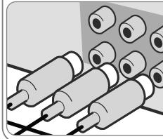
Соедините гнезда выходного компонентного видеосигнала ресивера COMPONENT VIDEO (PROGRESSIVE SCAN) OUTPUT с соответствующими гнездами телевизора кабелем Y PB PR.
