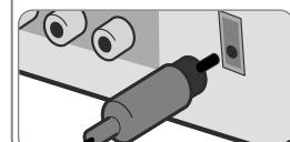
Подключите OPTICAL IN (оптический вход) к оптическому выходу телевизора (или цифрового устройства и т.д.)
