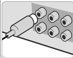
Соедините гнездо VIDEO OUTPUT (MONITOR) этого устройства с соответствующим входными гнездами телевизора кабелем видеосигнала.
