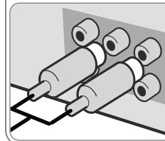
Гнезда входного аудиосигнала ресивера имеют цветовую маркировку (красный цвет – правый канал, белый цвет – левый канал). Если ваш телевизор оснащен только одним гнездом входного аудиосигнала (монофонический звук), подключите к нему левый канал ресивера (белое гнездо).
