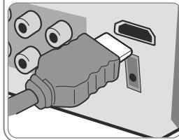
Соедините выходное гнездо HDMI OUTPUT ресивера с входным гнездом телевизора, оснащенного интерфейсом HDMI с помощью кабеля HDMI.
