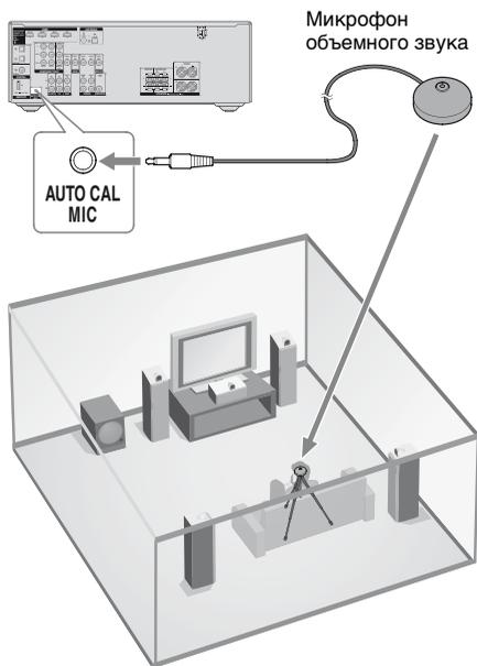
**1** Подключите прилагаемый микрофон оптимизатора к гнезду AUTO CAL MIC на задней панели.
