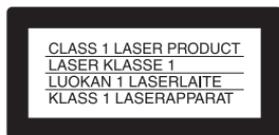
Данный аппарат классифицируется как ЛАЗЕРНОЕ изделие КЛАССА 1. МАРКИРОВКА ЛАЗЕРНОГО ИЗДЕЛИЯ КЛАССА 1 расположена на днище устройства.
