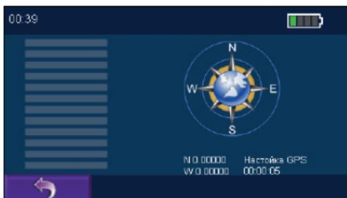
2. В данном окне Вы можете видеть долготу и широту текущего местоположения, текущую скорость, количество спутников и уровень сигнала каждого из них. Компас показывает местоположение спутников относительно Вашего местоположения.
