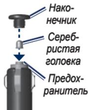
2. Извлеките предохранитель (стеклянный серебристый цилиндр) и замените его действующим предохранителем на 3 А.
