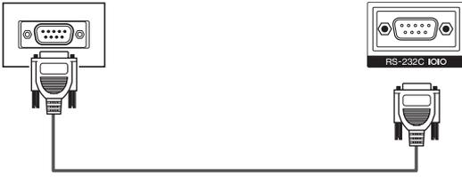
Последовательный управляющий кабель RS-232C (перекрестного типа)
