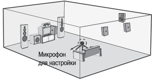
\* Во время измерений не держите микрофон в руках. Позаботьтесь о том, чтобы путь прохождения звука от акустических систем до микрофона не загромождали никакие предметы. Избегайте установки микрофона поблизости от спинки сиденья или стены, так как отражения звука могут повлиять на точность результатов измерений.
