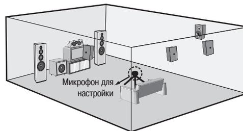
※ Во время измерений не держите микрофон в руках. Позаботьтесь о том, чтобы путь от микрофона до акустических систем не загромождали никакие предметы. Избегайте установки микрофона поблизости от спинки сиденья или стены, так как отражения звука могут повлиять на точность результатов измерений.
