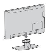
3 Закрепите телевизор на подставке с помощью прилагаемых винтов.
