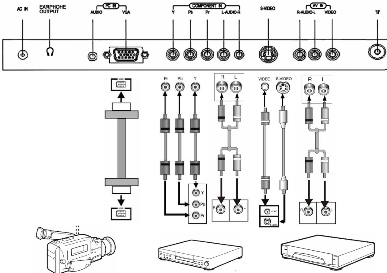
3. Подключите разъем кабеля VGA к соответствующему разъему компьютера, а другой разъем кабеля подключите к соответствующему разъему Вашего LCD телевизора. Закрутите винты на обеих сторонах по часовой стрелке.
