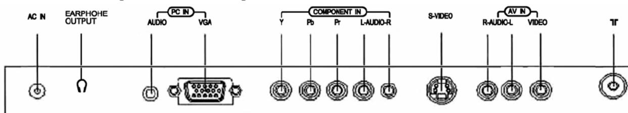
Входные разъемы, расположенные на задней панели Вашего LCD телевизора:
