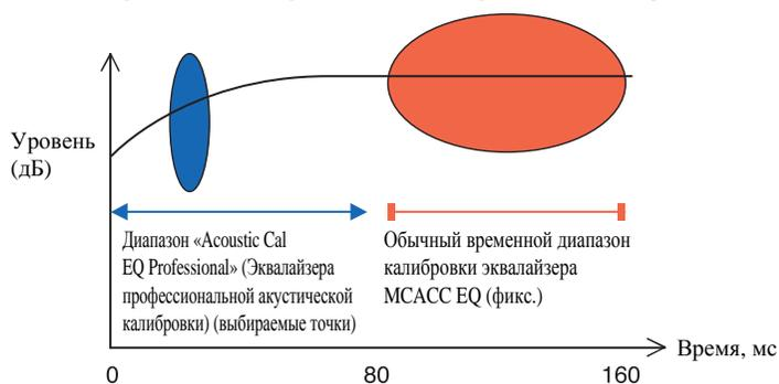
Для выбора временного периода калибровки «Advanced EQ Setup» (Расширенная настройка эквалайзера), просмотрите графики измеренных реверберационных характеристик и обратитесь к трем следующим примерам.
