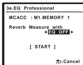
Для измерения характеристик реверберации помещения после коррекции, сначала выполните операцию «Auto MCACC (ALL)» (Автоматическая настройка MCACC (Все)), затем выберите «EQ ON» (Эквалайзер включен), затем «START» (Запуск). (См. [стр. 23](#).)
