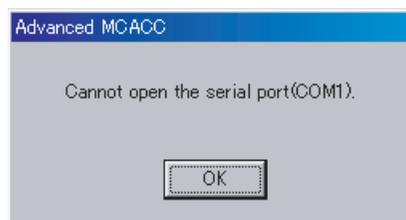
Обратитесь к руководству по эксплуатации используемого компьютера или прикладного программного обеспечения, использующего COM-порт, и обеспечьте доступность подключенного COM-порта для передачи.
