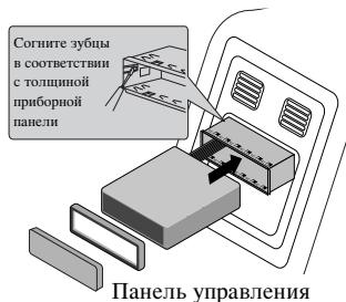
Перед началом установки обязательно переведите ключ зажигания в положение «выключено» и отключите клемму аккумулятора автомобиля, чтобы предотвратить короткое замыкание.
