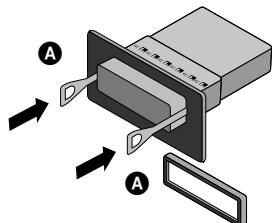
Если в приборной панели уже есть монтажный кожух для приемника, его следует удалить.
