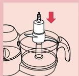
**1** Установите чашу на блок электродвигателя и установите насадку-тестомешалку на рамку для вставок, установленную в чашу.
