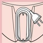
► Намотайте сетевой шнур вокруг барабана, расположенного на задней панели электроприбора.
