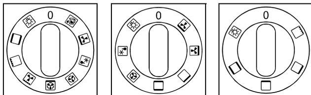
Ручка включения/выключения и выбора режима работы духовки (зависит от модели)
