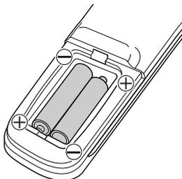
■ Вставьте батареи в соответствии с полярностью, указанной внутри батарейного отсека.
