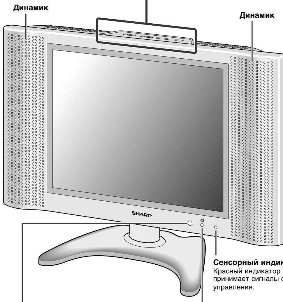
Для изменения вертикального положения телевизора наклоните экран на 5 градусов вперед или на 10 градусов назад. Телевизор можно также поворачивать на 25 градусов вправо или влево. Установите ракурс таким образом, чтобы просмотр телевизора был наиболее удобным. (См. пункт “Как установить угол наклона” на стр.9).
