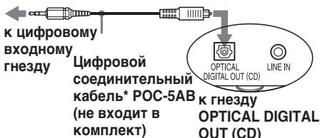
\* Выберите соединительный кабель в зависимости от типа подключаемого устройства. Подробную информацию см. в руководствах по эксплуатации подсоединяемых аппаратов. Гнездо OPTICAL DIGITAL OUT (CD) данного проигрывателя имеет квадратное сечение.
