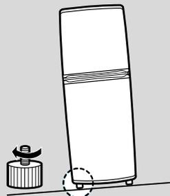
Если холодильник наклонен вправо, поверните правую переднюю регулировочную ножку против часовой стрелки.
