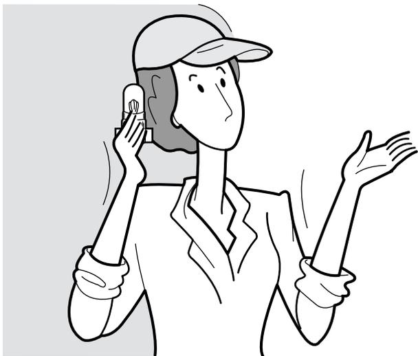
**1** Нажмите на верхнюю часть кожуха лампы каким-либо инструментом, например, отверткой с плоским концом и потяните его на себя.
