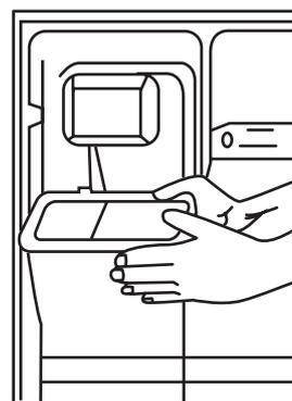
Если необходимо промыть резервуар, приподнимите его, а затем наклоните наружу, предварительно отсоединив соединительный шланг.
