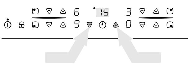
По истечении настроенного времени приготовления конфорка автоматически отключается, в течение двух минут звучит акустический сигнал, и индикатор таймера мигает **00**.
