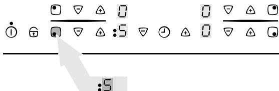
4. Для выключения наружного нагревательного контура прикоснуться к сенсорному полю "Трехконтурная конфорка"
